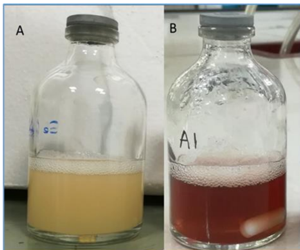
شکل شماره ۲. راست. تغییر رنگ محلول حاوی عصاره هیدروالکلی گیاه ریواس و محلول نیترات آلومینیوم از زرد (A) به قهوه‌ای تیره (B)؛ چپ. نتایج طیف‌سنجی UV-vis حاصل از نانوذرات آلومینا (a) و عصاره هیدروالکلی ریواس (b)
