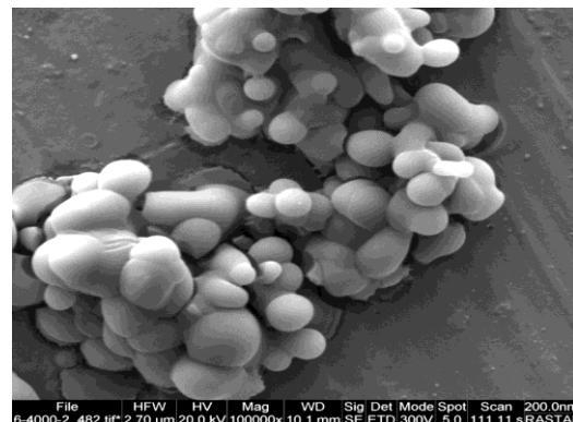
شکل شماره ۷. تصویر میکروسکوپ الکترونی FEI مدل Quanta 200 از نانوذرات کایتوزان (نانوذرات خشک شده بر سطح شیشه ای، روی گرید قرار گرفت و پس از پوشش دهی با طلا، تصویربرداری شد).
