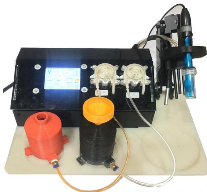
شکل شماره ۵. تصویر واقعی دستگاه سنجش pH مجهز به تنظیم‌کننده pH محلول خودکار
