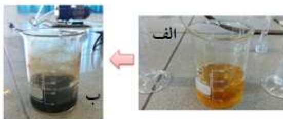
شکل شماره ۱. الف. عصاره تهیه شده از گیاه شکر تیغال؛ ب. محلول حاوی نانوذرات اکسید آهن سنتز شده (تغییر رنگ محلول نشان‌دهنده سنتز نانوذرات اکسید آهن است).
