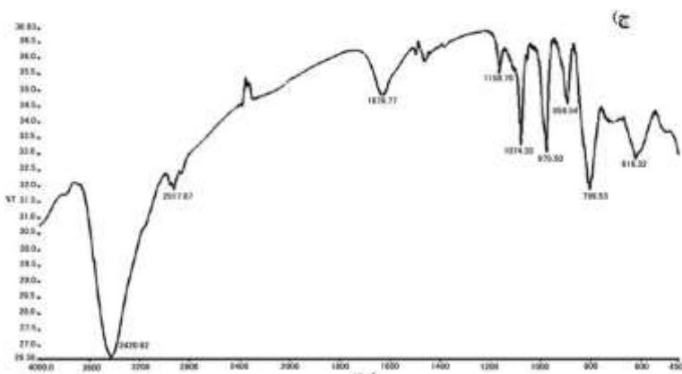
شکل شماره ۳. طیف FTIR؛ а. عصاره گیاه شکرتیغال؛ ب. نانوذرات اکسید آهن سنتزشده به کمک عصاره گیاه شکرتیغال؛ ج. نانوذرات اکسید آهن پوشش دهی شده با داروی کلرامفینیکل
