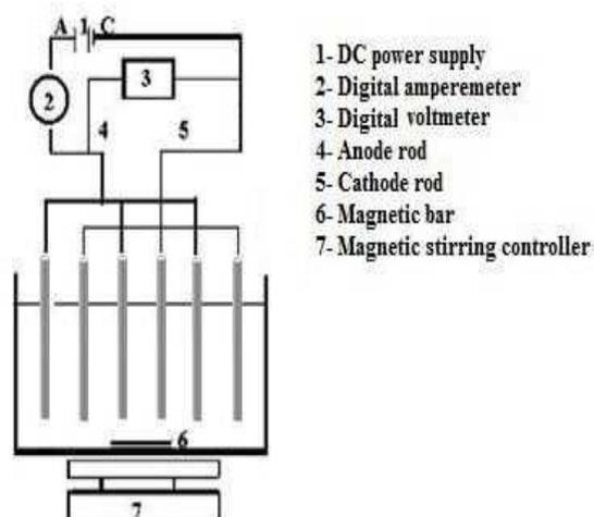
شکل ۱. پایلوت فرایند الکتروکواگولاسیون مورد استفاده در آزمایش
