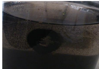
شکل شماره ۴. تصویر تاثیر میدان مغناطیسی روی نمونه Fe_3O_4
