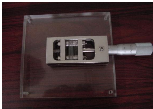
شکل شماره ۱. کلیماتور چند شکافه و نگهدارنده آن
