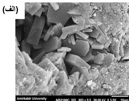
شکل (۳): تصویر (الف) FESEM زئولیت پروتونه اسید شویی شده و (ب) FESEM زئولیت پروتونه شده
