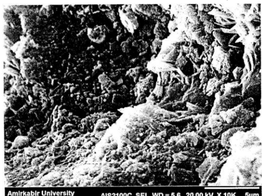
شکل شماره ۲. تصویر میکروسکوپ الکترونی SIM ژئولیت پس از شستشو با آب مقطر
