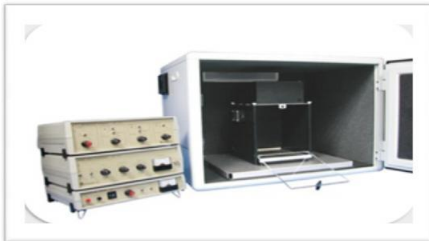
شکل شماره ۱. دستگاه Fear conditioning جهت سنجش حافظه ترس شرطی شده
