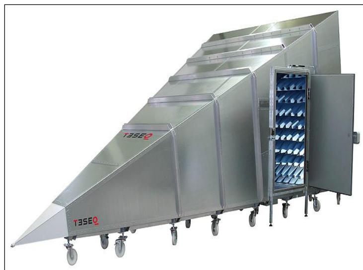
شکل شماره ۲. نمایی از اتاقک GTEM cell
