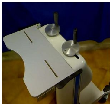
تصویر شماره ۳. ربات در حالت ارزیابی فلکشن-اکستنشن
