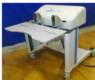
تصویر شماره ۲. ربات در حالت ارزیابی سوپینیشن-پرونیشن
