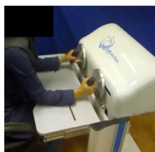
تصویر شماره ۲. ربات در حالت ارزیابی سوپینیشن-پرونیشن
