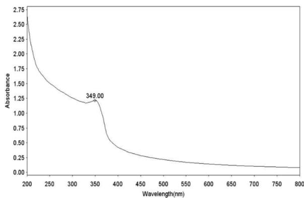
شکل شماره ۲. نمودار طیف UV-vis نانوذرات اکسیدروی سنتز شده به کمک عصاره هسته ازگیل ژاپنی
