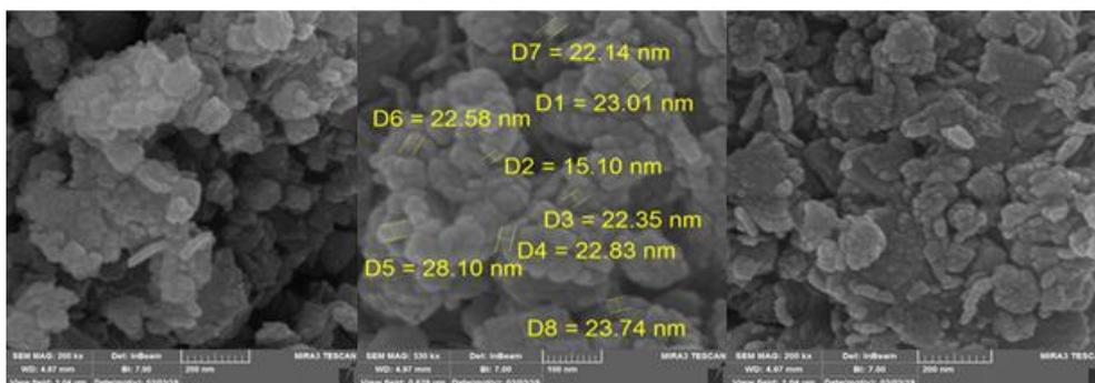
شکل شماره ۳. تصاویر میکروسکوپی FE-SEM نانوذرات اکسیدروی سنتز شده به کمک عصاره هسته ازگیل ژاپنی
