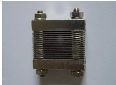
شکل شماره ۱. کلیماتور چند شکافه و نگهدارنده آن
