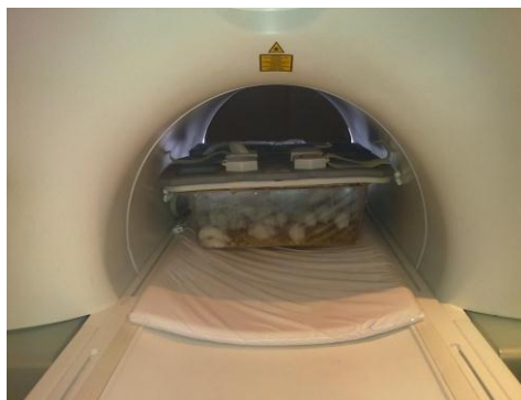
شکل شماره ۱. نحوه قرارگیری محفظه پلاستیکی حاوی موش ها جهت تابش امواج دستگاه MRI ۱/۵ تسلا
