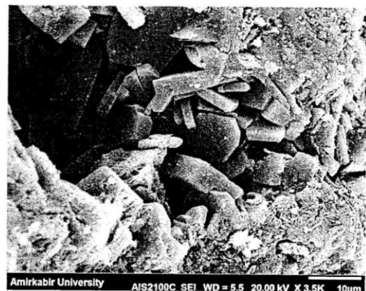
شکل شماره ۱. تصویر میکروسکوپ الکترونی SIM ژئولیت قبل از شستشو با آب مقطر
