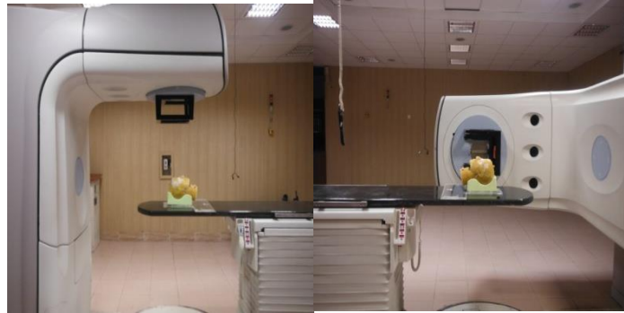
شکل شماره ۳. فنتوم قرار گرفته روی تخت شتابدهنده جهت تابش دهی
