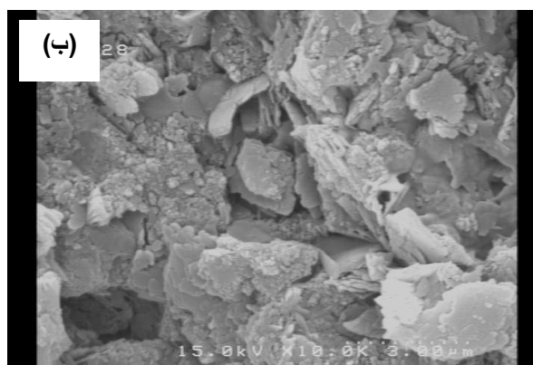
شکل شماره ۲. تصویر (الف) XRD (پراش اشعه ایکس) ژئولیت پروتونه شده و (ب) FESEM (تصویر میکروسکوپ الکترونی) ژئولیت خام
