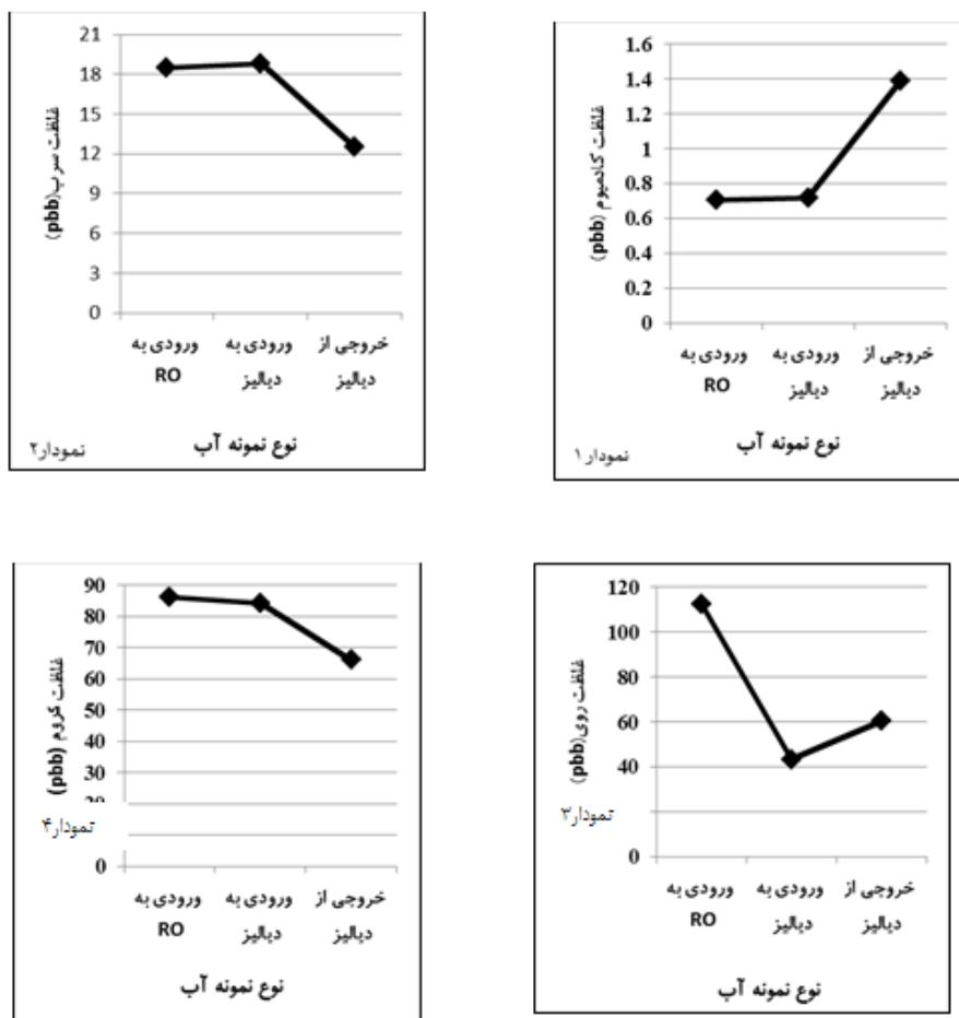
نمودارهای شماره ۴-۱. روند تغییرات فلزات سرب، کادمیوم، کروم و روی در آب ورودی به اسمز معکوس و آب ورودی و خروجی از دستگاه دیالیز
