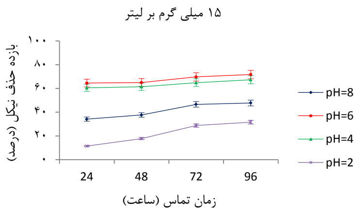
نمودار شماره ۲. اثر زمان تماس و pH های مختلف بر بازده حذف نیکل (II) با سویه Micrococcus luteus SEHD031RS در غلظت ۱۵ میلی گرم بر لیتر بر حسب درصد (سرعت اختلاط: ۲۰۰ دور بر دقیقه، دمای محیط ۲۵ درجه سانتی گراد)
