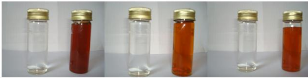
شکل شماره ۱. تغییرات رنگ در تشکیل نانوذرات نقره. مایع بی رنگ نیترات نقره، نانوذرات نقره سنتز شده از (آ) مان بلوط، (ب) صمغ گیلاس، (پ) صمغ زردآلو.
