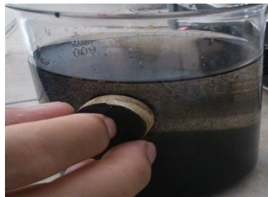
شکل شماره ۴. تصویر تاثیر میدان مغناطیسی روی نمونه Fe_3O_4
