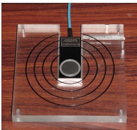
شکل شماره ۳. نگهدارنده افقی برای اتاقک یونیزاسیون و کلیماتور تک شکافه از جنس تنگستن
