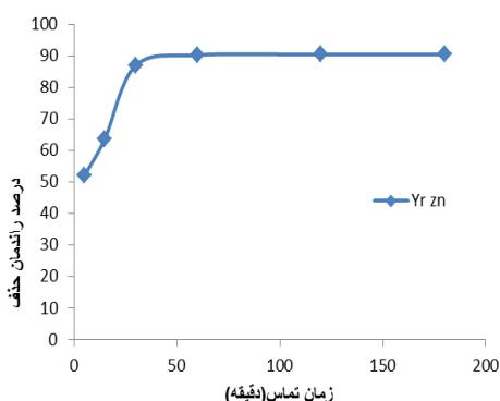
شکل شماره ۲. اثر زمان تماس در حذف یون های فلزی روی در pH=۷، دوز جاذب ۲ g/L و غلظت اولیه یون های فلزی ۵۰ mg/L در نمونه سنتیک
