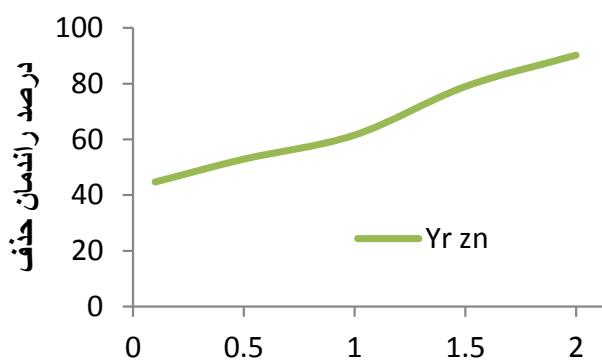
شکل شماره ۴. اثر وزن جاذب بر روی جذب در زمان تماس ۶۰ دقیقه، غلظت اولیه فلز  $50 \text{ mg/L}$ ، دمای  $25^\circ\text{C}$  درجه سانتی گراد و  $pH = 7$  در نمونه سنتیک
