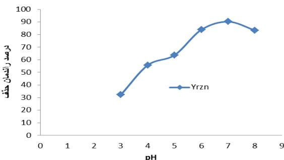
شکل شماره ۱. اثر pH در حذف یون های فلزی روی در زمان تماس ۶۰ دقیقه، دوز جاذب ۲ g/L، دمای ۲۵ درجه سانتی گراد و غلظت اولیه یون های فلزی ۵۰ mg/L در نمونه سنتیک
