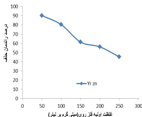
شکل شماره ۳. اثر غلظت اولیه فلز در نمونه سنتیک بر روی جذب در زمان تماس ۶۰ دقیقه، دوز جاذب ۲ g/L، دمای ۲۵ درجه سانتی گراد و pH=7
