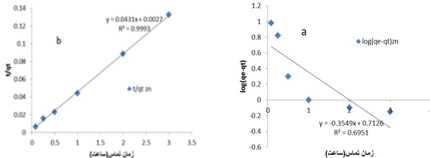
شکل شماره ۶. سنتیک شبیه درجه یک(a) و سنتیک شبیه درجه دو(b) حذف روی با جلبک کلرلا ولگاریس در نمونه سنتیک
