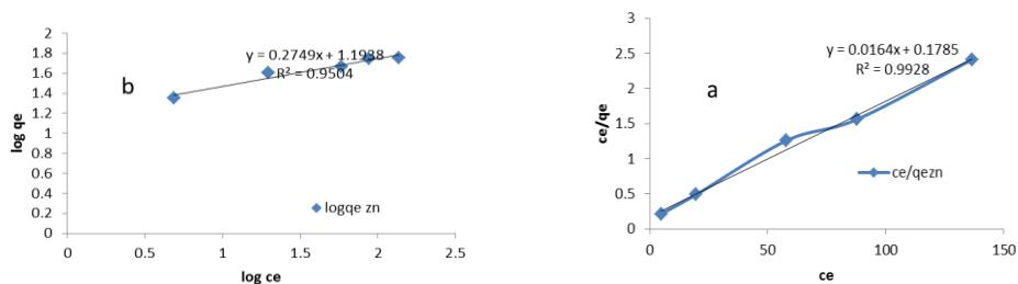
شکل شماره ۵. مدل ایزوترم لانگمیر(a)، ایزوترم فرونالدیخ(b) برای کارایی حذف روی در نمونه سنتیک
