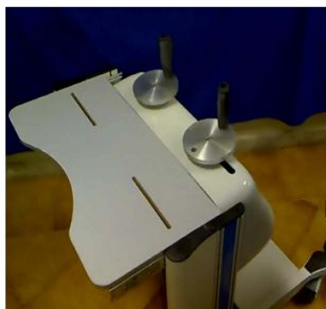
تصویر شماره ۳. ربات در حالت ارزیابی فلکشن-اکستنشن
